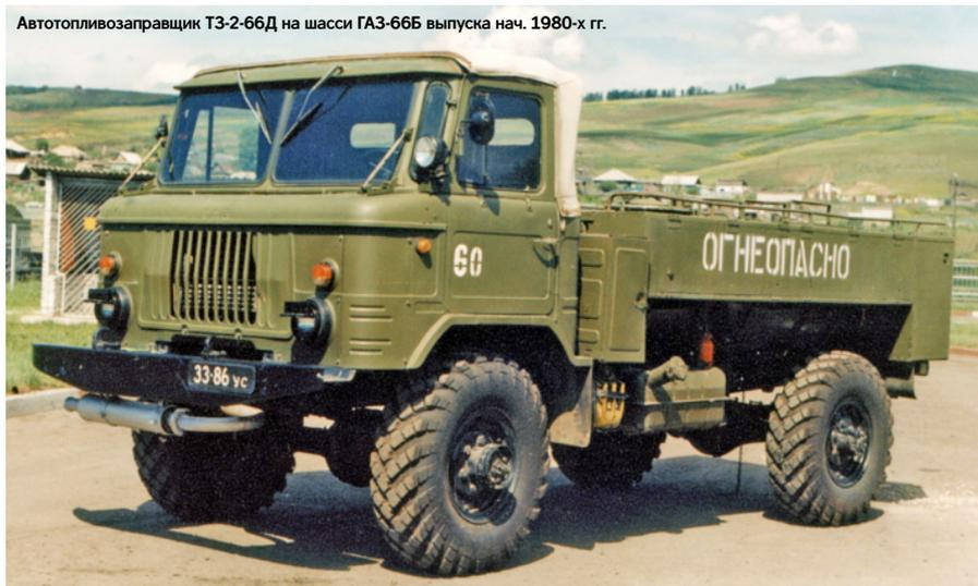
чил устройство для обмыва ветрового стекла. Для уверенного и быстрого запуска двигателя при низких температурах машина оснащалась пусковым безламповым подогревателем модели ПЖБ-12. Кабина имела эффективную систе-
