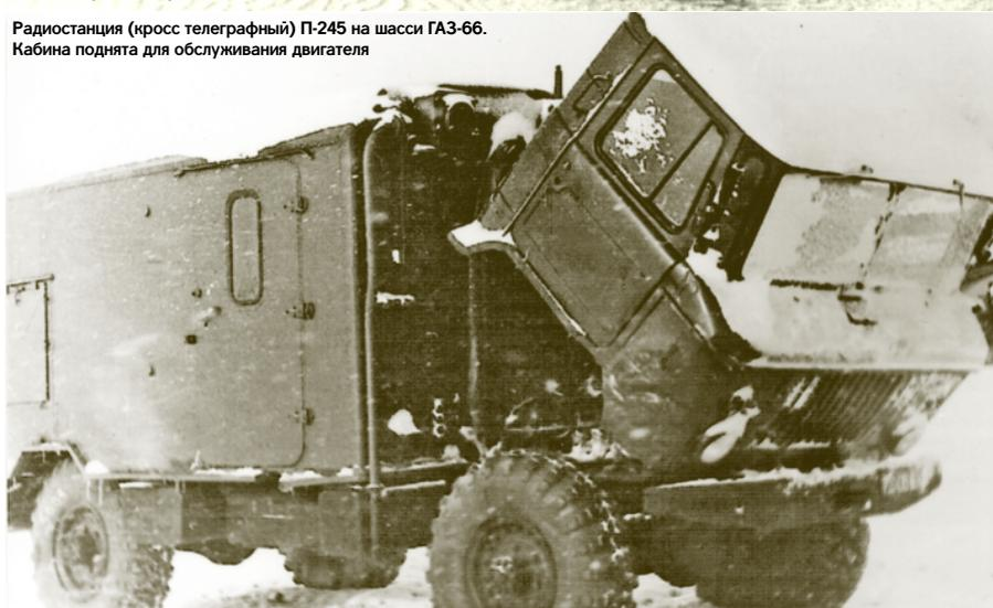
Радиостанция (кросс телеграфный) П-245 на шасси GAZ-66. Кабина поднята для обслуживания двигателя
