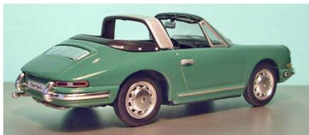
В 1965 г. фирма Porsche представила свою версию кабриолета на базе 911-й модели, причём, весьма интересную. Она была оснащена массивной защитной дугой позади кресел салона. Имела съёмную пластиковую крышу и пристёгивавшийся к дуге задний полог с целлюлоидными оконцами (в 1969 г. этот полог был заменён стационарным панорамным задним стеклом). Новинка даже получила собственное имя — «Тарга», в честь побед автомобилей фирмы Porsche в гонках Тарга Флорио на Сицилии.
